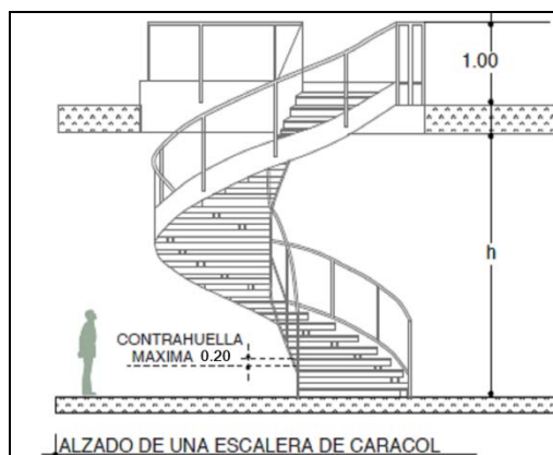
FIGURA 13 DETALLES ESCALERA TIPO CARACOL
